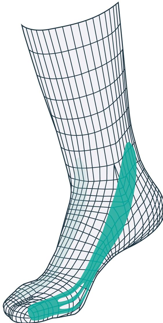
An der Innenseite der Taping Socken sind gerichtete Züge (Tapes) eingearbeitet, die je nach Ausführung variieren und somit gezielt den typischen Fehlorientierungen entgegenwirken.
